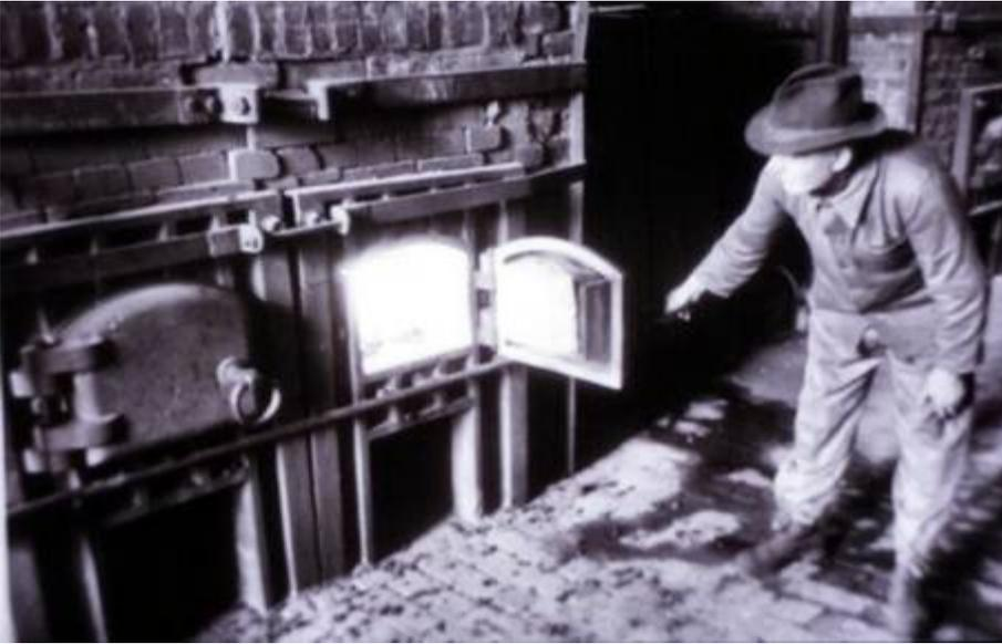
Ofenklappen an einer Destillationsblase.
